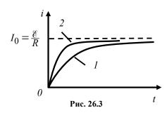
Функция (26.5) описывает нарастание силы тока в цепи после подключения к ней источника ЭДС. График зависимости силы тока от времени для двух электрических цепей, содержащих катушки с различными значения-
