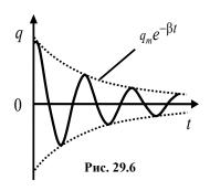
График затухающих колебаний заряда на обкладках конденсатора приведен на рис. 29.6.
