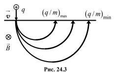
Пусть пучок частиц, прошедших сепаратор, попадает в однородное магнитное поле, магнитная индукция которого перпендикулярна скорости частиц. Тогда частицы пучка, масса которых равна  $m_i$ , будут согласно (24.2) в дальнейшем двигаться по окружности радиусом
