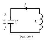
Определим закон изменения заряда конденсатора во времени. Для этого составим дифференциальное уравнение колебаний в колебательном контуре, схема которого приведена на рис. 29.2. Запишем закон Ома для участка цепи I-2, приняв, что направление тока соответствует зарядке конденсатора:
