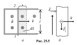
контур, участок которого I—2 длиной l может перемещаться без нарушения контакта с остальной частью контура (рис. 25.5, a).
