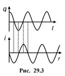
Из сопоставления уравнений (29.4) и (29.6) видно, что колебания силы тока в контуре опережают колебания заряда по фазе на  $\pi/2$ , а по времени — на четверть периода. Графики изменения заряда конденсатора и силы тока в колебательном контуре при  $\alpha=0$  представлены на рис. 29.3.
