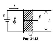
Допустим, что провод с током может свободно перемещаться во внешнем магнитном поле под действием силы Ампера. Это можно осуществить с помощью скользящих контактов между концами провода и остальными участками замкнутой цепи (рис. 24.13). Внешнее поле будем предполагать однородным.
