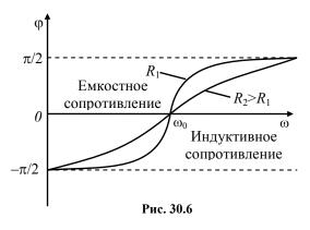
Зависимость фазового сдвига между ЭДС и силой тока от частоты вынуждающей ЭДС приведена на рис. 30.6. При частоте, меньшей частоты собственных колебаний, реактивное сопротивление контура имеет емкостной
