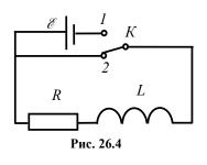
Теперь рассмотрим случай размыкания цепи (рис. 26.4). Перебросим ключ K из положения I в положение 2, тем самым отключим источник и замкнем цепь, включающую резистор R и катушку индуктивности L. В момент замыкания цепи в катушке индуктивности существовал ток силой  $I_0$ .
