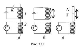
Для ответа на этот вопрос поставим второй опыт (рис. 25.1,  $\delta$ ). Теперь катушка I постоянно подключена к источнику, поэтому ток в ней неизменен. Однако в процессе смещения катушек
